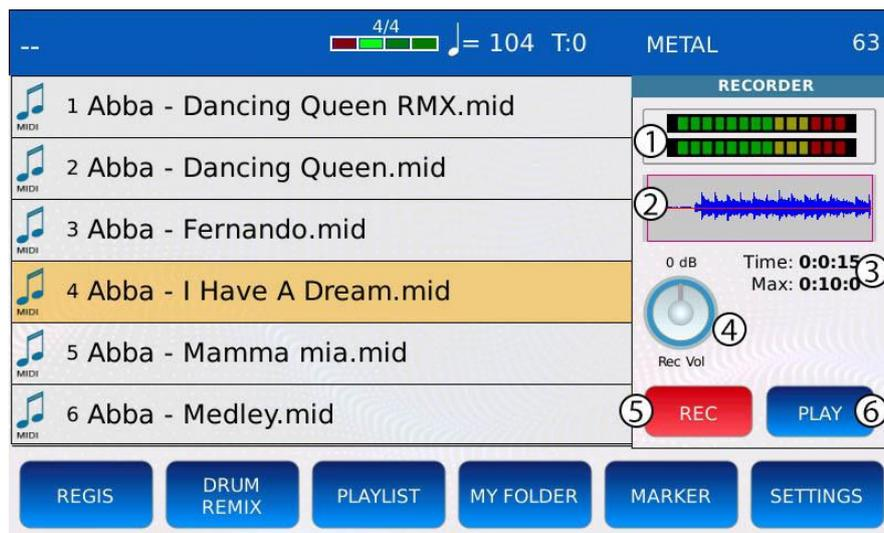
1. VU-Meter: geben eine visuelle Darstellung des Audiosignalpegels. Wenn die Anzeigen grün oder gelb sind, liegt das Eingangssignal unterhalb der Verzerrungsschwelle. Wenn die Anzeigen rot sind, ist das Eingangssignal zu laut und die Aufnahme wird abgeschnitten.
